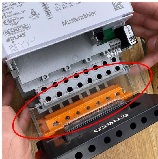
Berührungsschutzglas schützt den Elektriker beim Wechsel des Zählers beim Arbeiten unter Spannung (Zählerstifte sind stromführend)
